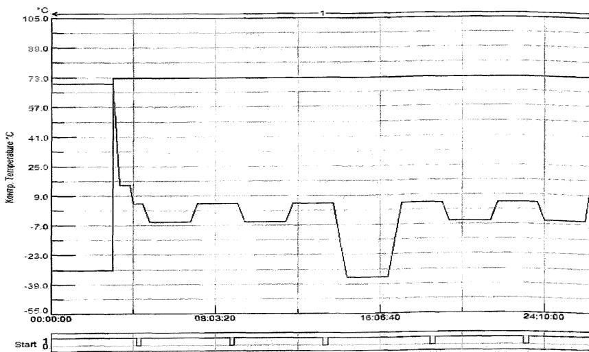
Рисунок A.1 – Графическая модель одного цикла климатических испытаний
